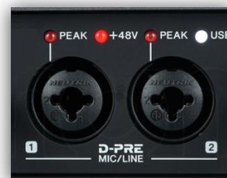
Разъёмы combo inputs
